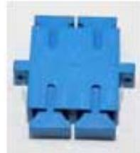
Mellanstycket är tillverkade av plast (PBT). Hylsan är av "Zirconica Sleeve" (Zrc) till Singelmod och "Fusförbron" (Phbr) till Multimod. Klarar minst 500 in/urkopplingar. Erfordrad kraft för urdragning av kontakt >100N. Dämpningsvariation efter 500 in/urkopplingar + 0,20dB. Förvaringstemperatur -40 till +80°C. Driftstemperatur 40 till +60°C. Samtliga mellanstycken uppfyller kraven i enlighet med Telcordia GR 326 CORE Utgåva 3, 1999. Monteringsmått duplex: 25,9 x 9,4mm.
